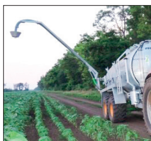
Obracanie i podnoszenie za pomocą siłowników hydraulicznych
